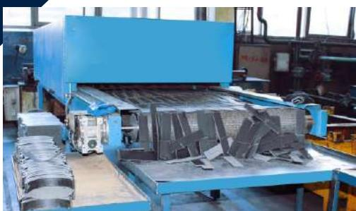
Тормозные колодки, выпущенные компанией «Начало», полностью соответствуют техническим характеристикам. Более того, на предприятии существуют сборочные стенды собственной разработки, которые обеспечивают отсутствие распространенных дефектов у некоторых производителей: смещение или сползание фрикционной накладки относительно обода, зазоров между ободом и накладкой. Усилия стенда обеспечивают, чтобы фрикционные накладки приклеились с максимальным запасом прочности.
