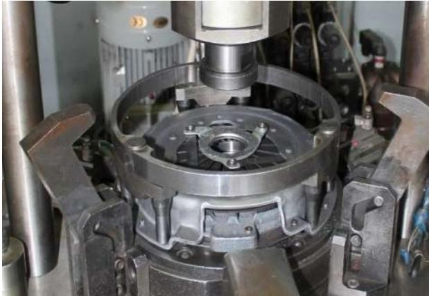
ИСПЫТАТЕЛЬНЫЙ СТЕНД КОРЗИН ДЛЯ
