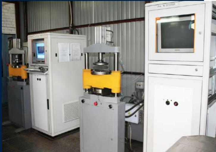
СТЕНДЫ ДЛЯ ОПРЕДЕЛЕНИЯ НАГРУЗОЧНЫХ
